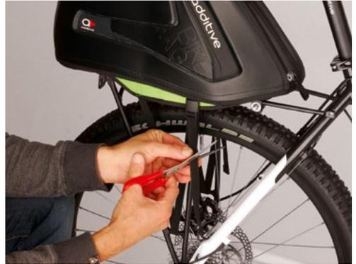
Spannriemen an horizontalem Querrohr umlegen und mit den Verschlüssen befestigen.
