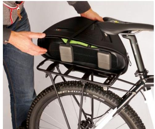
In die freien Felder des Gepäckträgers die beiden Rastblöcke mit dem Klettverschluss nach oben einlegen. Tasche in gewünschter Position auf dem Gepäckträger aufsetzen und die Rastblöcke von unten an den Taschenboden andrücken. Tasche wieder abnehmen und die Rastblöcke in endgültige Lage richten und andrücken. Tasche erneut aufsetzen. Ggf. müssen die Rastblöcke mit einem scharfen Messer auf Maß zugeschnitten werden.
