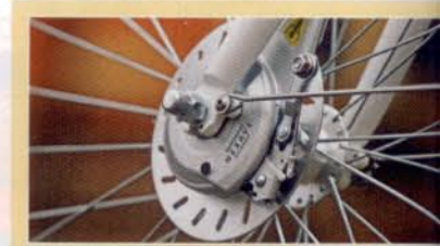
Shimanos Rollenbremse ist wartungsarm, gut dosierbar und noch selten.
